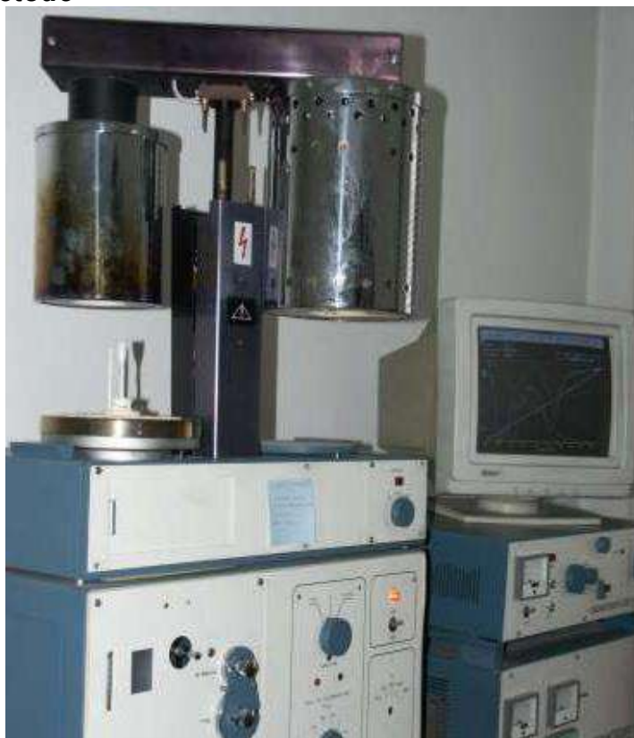
MOM tip Paulik-Paulik-Erdey, Q 1500 -Creuzete din platină -Cuptor calcinare 1000°C
